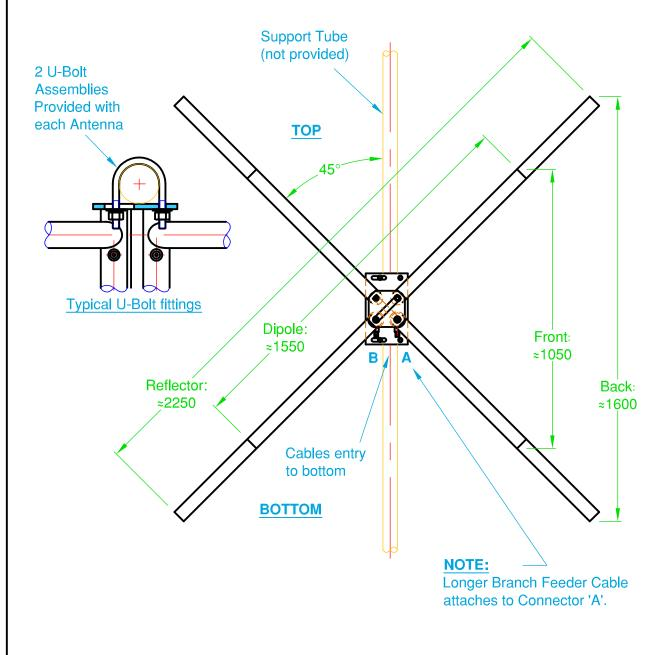
**TOP FRONT BACK** Dipole Tube Reflector Tube
